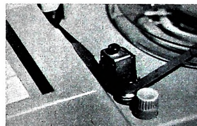
Bild 2. Im Tonbandgerät eingebauter Impulskopf
